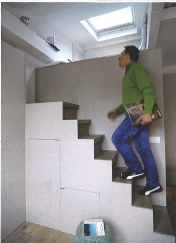
La mezzanine. Pour installer le lit, il a fallu refaire un plancher bois. Cette plate-forme, reposant sur la poutre d'origine, a également permis de créer des rangements sous les rampants. L'escalier qui y mène a été réalisé sur mesure en chêne lasuré gris. Il est doté de deux rangements d'une profondeur de 50 cm complétant un grand dressing qui a été installé perpendiculairement.
